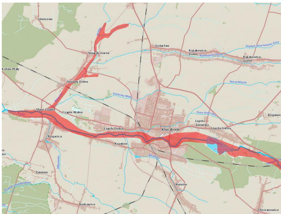
Miasto Kluczbork: ryzyko powodziowe na rzece Stobrawie zostało prawie całkowicie zniwelowane budowlą hydrotechniczną „Zbiornik Retencyjny Kluczbork” ale nie można wykluczyć całkowitego zagrożenia, gdyż może zaistnieć sytuacja podtopienia spowodowana awaryjnym zrzutem wody ze zbiornika retencyjnego. W przypadku gdy przyptyw wody do zbiornika jest tak duży, że grozi to uszkodzeniem urządzeń hydrotechnicznych, niezbędnym staje się awaryjny zrzut nadwyżki zgromadzonej wody i w takiej sytuacji zagrożone będą Park Miejski, ul. Strzelecka, Słoneczna, Korfantego, ul. Księcia Poniatowskiego, ul. Generała Bema, m. Czaple Stare i m. Krezel.
